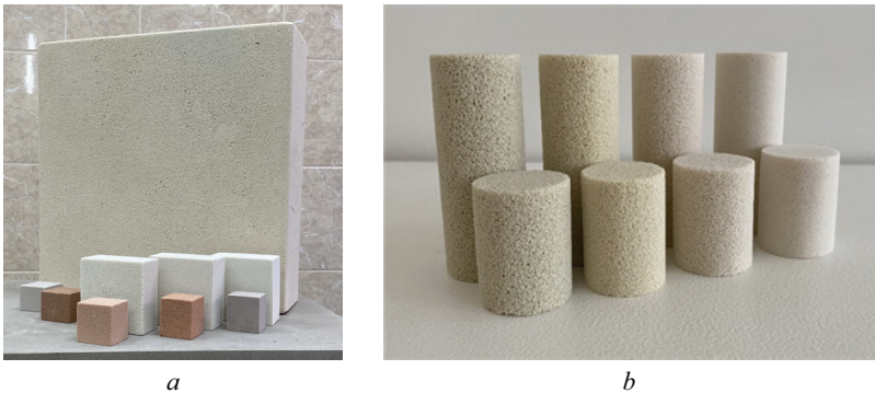
Рис. 1. Фото образцов ПСК (a) и образцов, подготовленных для испытания в импедансной трубе (b)
