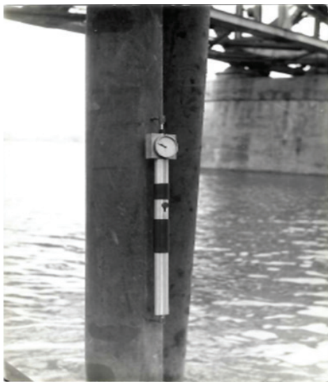
Рис. 4. Измерение относительных деформаций элементов опоры деформетром с базой 505 мм Fig. 4. Measurement of relative deformations of support elements with a deformometer with a base of 505 mm
