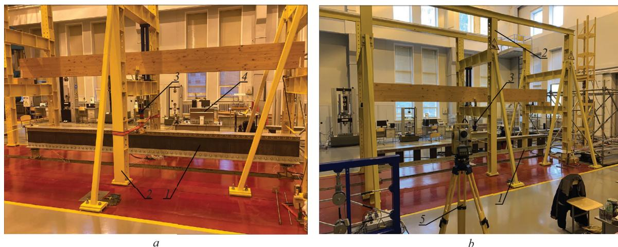
Рис. 3. Испытательный стенд и экспериментальные образцы из ПСП: *a* — со сплошной стенкой; *b* — с перфорированной стенкой: 1 — экспериментальный образец, 2 — испытательный стенд, 3 — гидравлический домкрат, 4 — тензостанция, 5 — тахеометр
