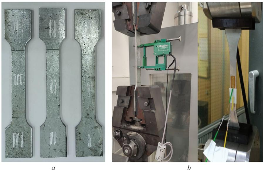
Рис. 5. Испытания на растяжение: а — типичный вид образцов; б — тензометрическое оборудование
