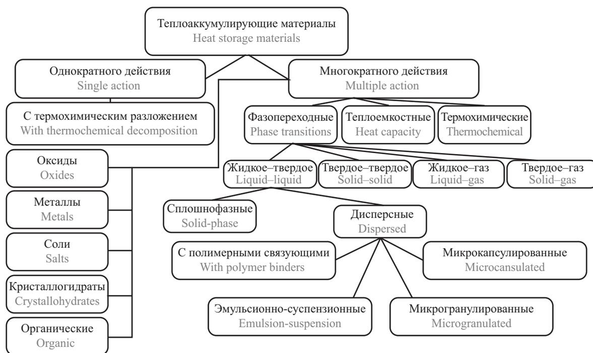
Рис. 2. Классификация теплоаккумулирующих материалов
