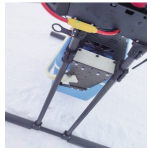
Рис. 2. Система крепления контейнера для перевозки компонентов крови на БПЛА Fig. 2. System of fixing the container for transportation of blood components on the UAV
