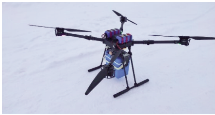
Рис. 1. Беспилотный летательный аппарат (БПЛА) с зафиксированным контейнером для перевозки компонентов крови Fig. 1. Unmanned aerial vehicle (UAV) with fixed container for transportation of blood components
