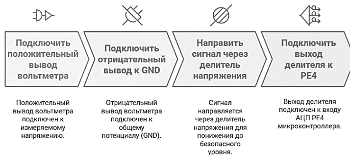
Рис. 4. Алгоритм подключения вольтметра к аналого-цифровому преобразователю микроконтроллера
