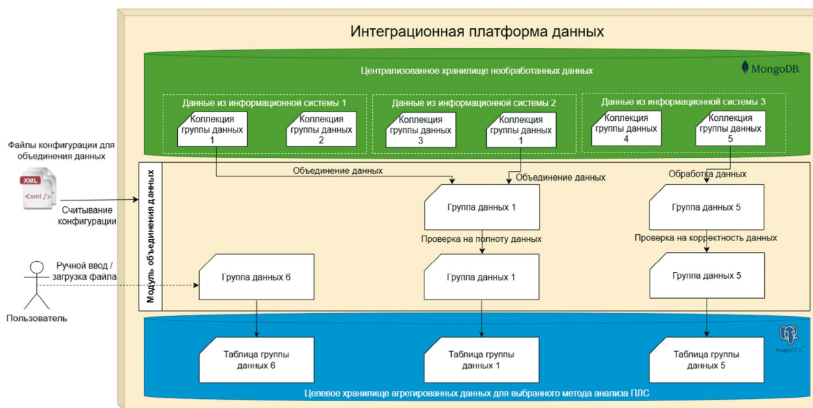
Рис. 2. Модель процесса объединения данных в интеграционной платформе
