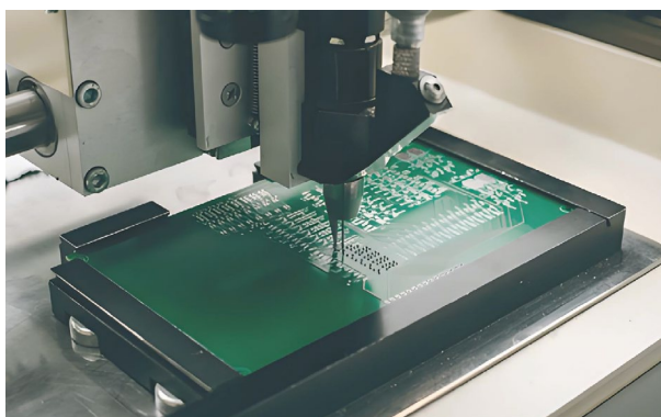
Рис. 1. Сборка печатной платы при помощи специальных автоматизированных установок
