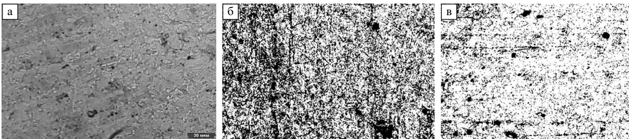
Рис. 4. Фотографии микроструктуры образцов после термической обработки по режимам табл. 3: а) режим № 1; б) режим № 2; в) режим № 3
