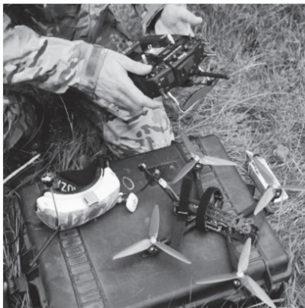
Рис. 1. Комплект управления FPV БПЛА
