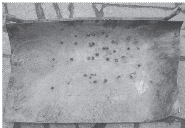
Рис. 7. Вид бронепластины стендового оборудования после испытаний
