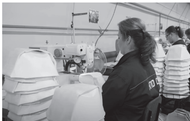
Рис. 7. Процесс изготовления заготовок из СВМПЭ «РУССИЛ» для шлемов защитных «Колпак 20»
