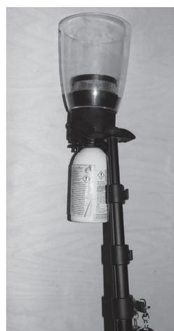
Рис. 22. Радиоуправляемый дымогенератор мобильный «МР»
