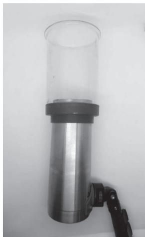
Рис. 23. Универсальное устройство для проверки тепловых, дымовых и газовых пожарных извещателей
