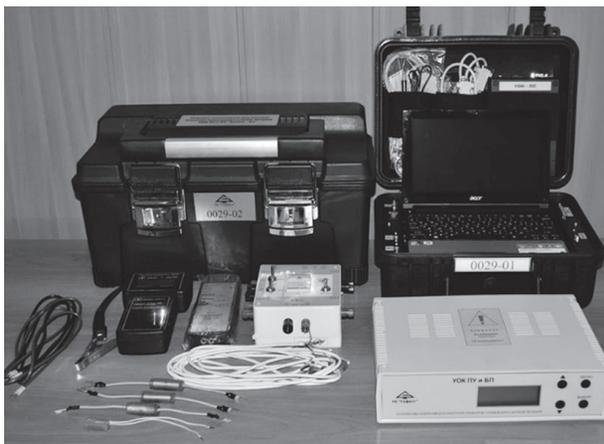
Рис. 5. Комплект оперативной диагностики пожарной сигнализации КОД-ПС «Шлейф-М1», блоков питания и ППУ «Линия-М1»
