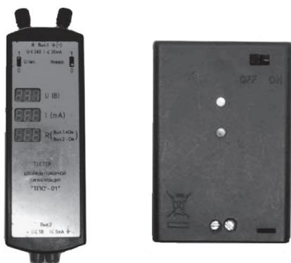
Рис. 19. Тестер пожарной сигнализации ТПС-01 и его упрощенная версия (без индикаторов)
