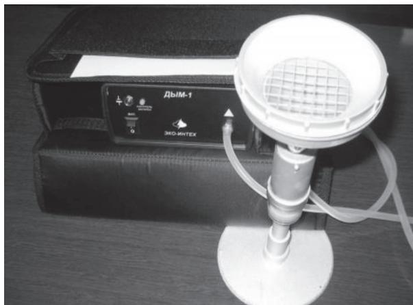
Рис. 15. Тестер дымовых пожарных извещателей «Дым-1»
