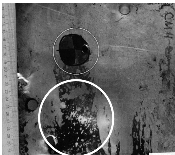
Рис. 9. Оплавление алюминиевого листа при испытании образца № 8
