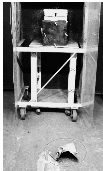
Рис. 5. Вид алюминиевого листа после испытаний образца № 2
