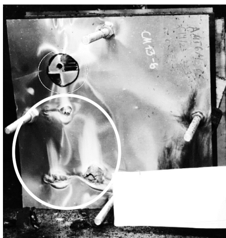
Рис. 8. Оплавления алюминиевого листа при испытании образца № 9
