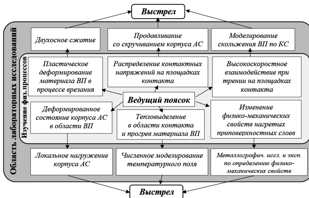
Рис. 2. Блок-схема алгоритма исследования физических процессов, протекающих в ведущем пояске при выстреле
