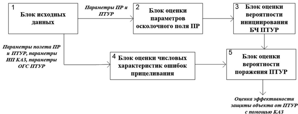
Рис. 1. Структурная схема имитационной модели физической защиты объектов ВВСТ от противотанковых управляемых ракет
