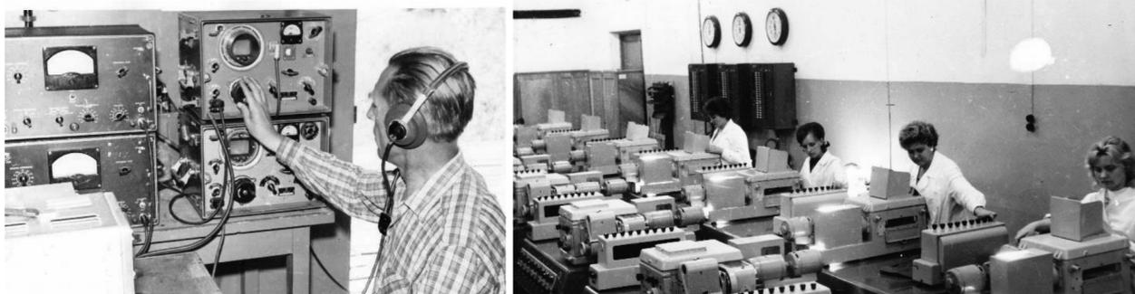
Рис. 4. Регистрация баллистических (слева) и динамических (справа) параметров работающего ПГД на полигоне «Ржевка». Середина 60-х — начало 70-х гг. XX века. Фото из личного архива Л.Т. Фоменко
