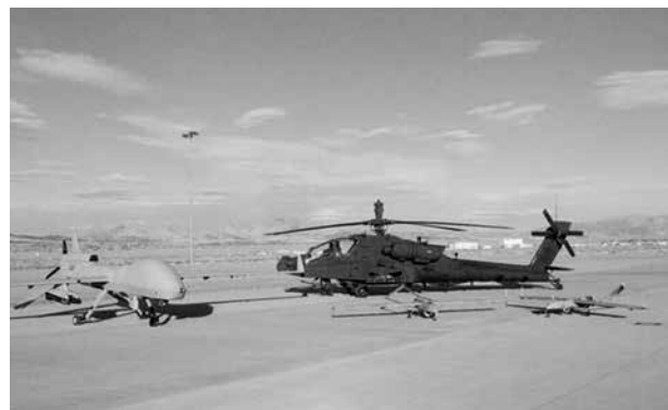
Рис. 1. Боевой вертолет AH-64E с системой MUM-T-X для взаимодействия с БПЛА MQ-1C (слева) и RQ-7B (справа)
