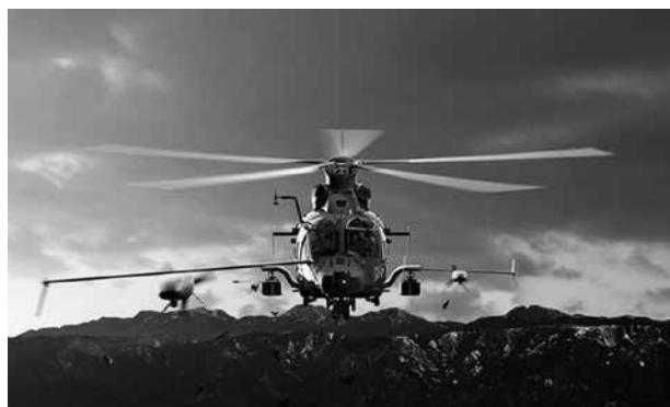
Рис. 3. Концепт легкого боевого вертолёта (ЛАН) проекта MUM-T компании KAI в сопровождении БЛА воздушного базирования (ALE)
