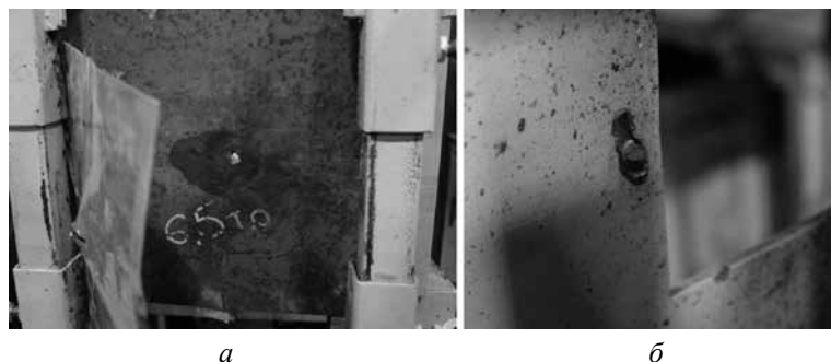
Рис. 2. Образец 1 после испытаний: а — вид со стороны удара; б — сердечник пули, застрявший в защитном кожухе оптического скоростемера
