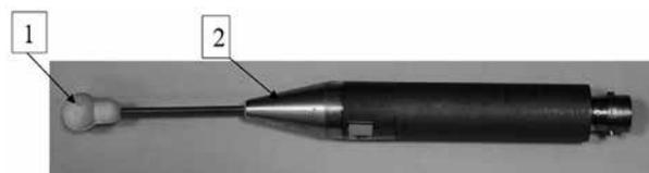
Рис. 3. Вид пьезоэлектрического датчика давления ПД-7-1,5М: 1 — преобразователь давления; 2 — предварительный усилитель
