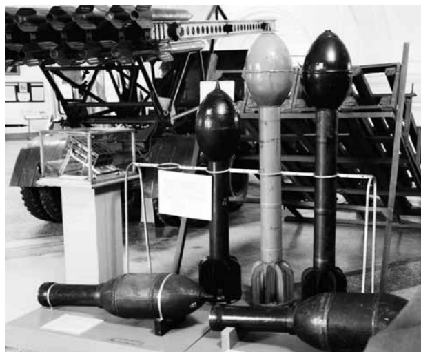
Рис. 4. Стоят слева направо: 300-мм реактивные фугасные снаряды М-30, М-31, М-31УК (улучшенной кучности за счет проворота снаряда). Проворот достигался установкой в центре тяжести РС четырех Г-образных штуцеров
