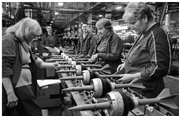
Рис. 2. Изготовление изделий 3БМ42 на механическом заводе
