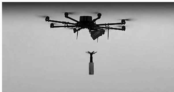
Рис. 1. БПЛА R-18 в момент сброса кумулятивной гранаты (производство Украина)
