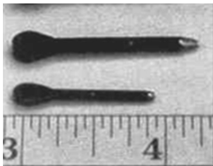
Рис. 5. Вид СПЭ к шрапнельным снарядам
