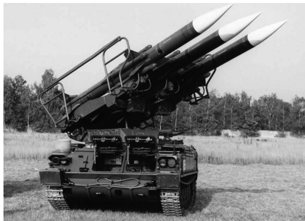
Рис. 11. Пусковая установка 9П12 зенитного комплекса «Куб»
