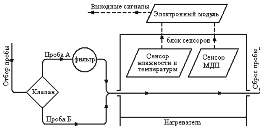
Рис. 3. Функциональная схема детектора ПДК
