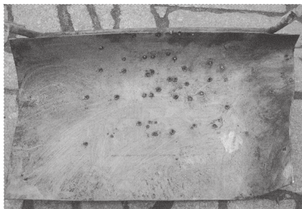
Рис. 7. Вид бронепластины стендового оборудования после испытаний
