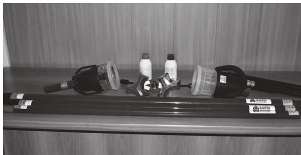
Рис. 6. Внешний вид комплекта для проверки тепловых (слева) и дымовых/газовых (справа) пожарных извещателей с комплектом тестовых аэрозолей имитирующих газ СО (слева) и дым (справа)
