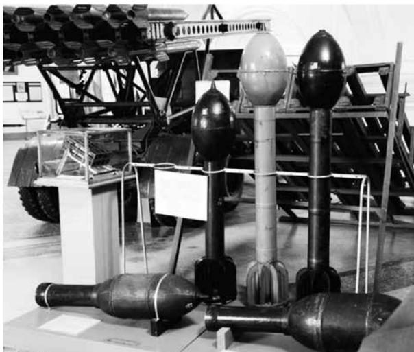
Рис. 4. Стоят слева направо: 300-мм реактивные фугасные снаряды М-30, М-31, М-31УК (улучшенной кучности за счет проворота снаряда). Поворот достигался установкой в центре тяжести РС четырех Г-образных итуцеров
