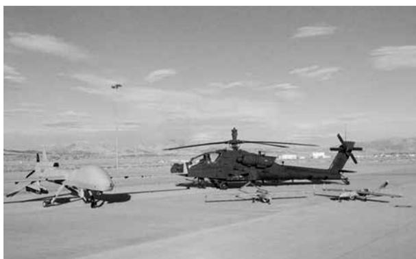
*Рис. 1. Боевой вертолет AH-64E с системой MUM-T-X для взаимодействия с БПЛА MQ-1C (слева) и RQ-7B (справа)*
