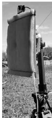
Рис. 6. Акустическая камера OptiNav ACAM 120
