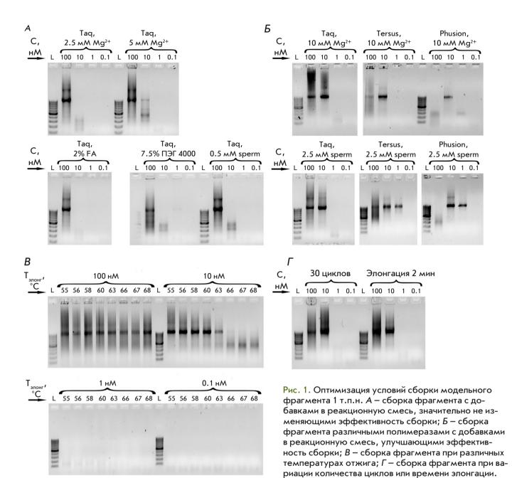
лученными результатами, оптимальный диапазон концентраций олигонуклеотидов для сборки фрагментов ДНК находится в районе десятков нМ и немного варьирует в зависимости от состава реакционной смеси. В реакционной смеси мы варьировали концентрацию ионов  ${\rm Mg^{2+}}$  (2.5, 5 и 10 мМ) и выяснили, что она оказывает значимое влияние на получение финального продукта — фрагменты гораздо лучше собираются в присутствии 10 мМ  ${\rm Mg^{2+}}$ , хотя такие большие концентрации уже не используются
