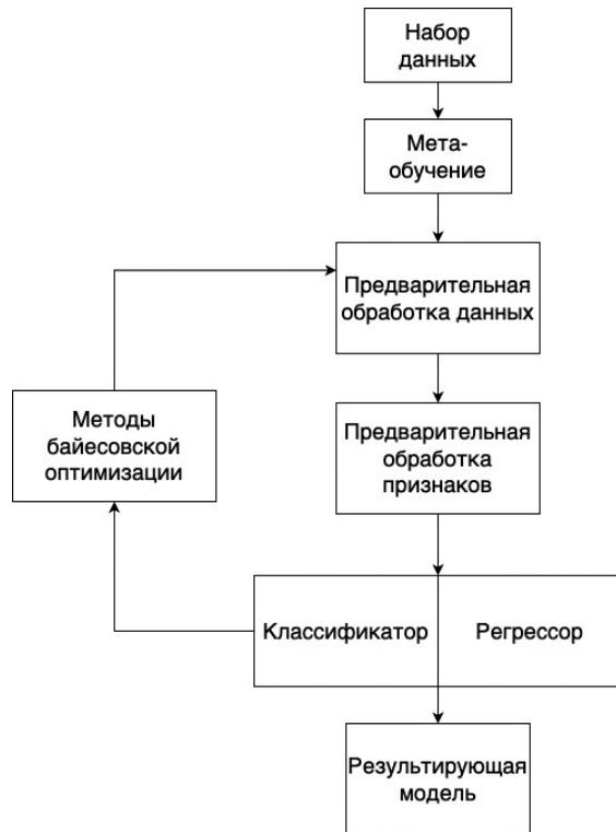
Рис. 5. Общая схема конвейера Auto-Sklearn
