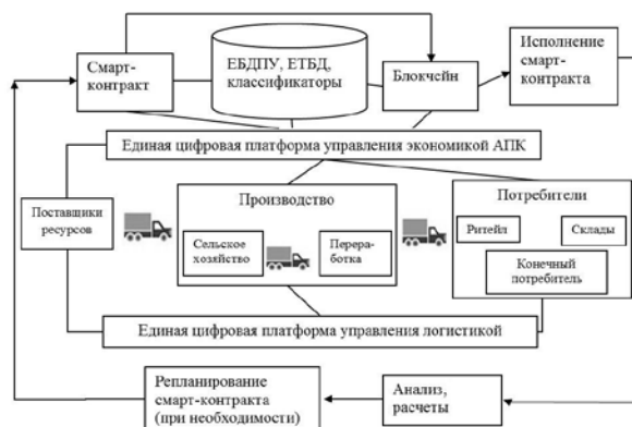
Рис. 3. Схема прослеживаемости продукции при интеграции ЦПУ АПК и ЦПУ логистики
