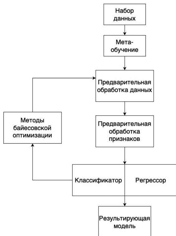
Рис. 5. Общая схема конвейера Auto-Sklearn
