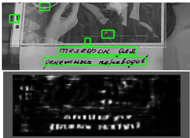
Рис. 6. Пример ложных срабатываний предложенного подхода поиска текста. Лишние найденные рамки на фоне удаляются после этапа распознавания строк
