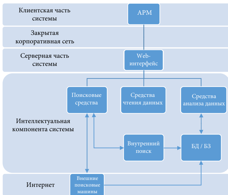
Рисунок 2. Схема портала с интеллектуальной компонентой
