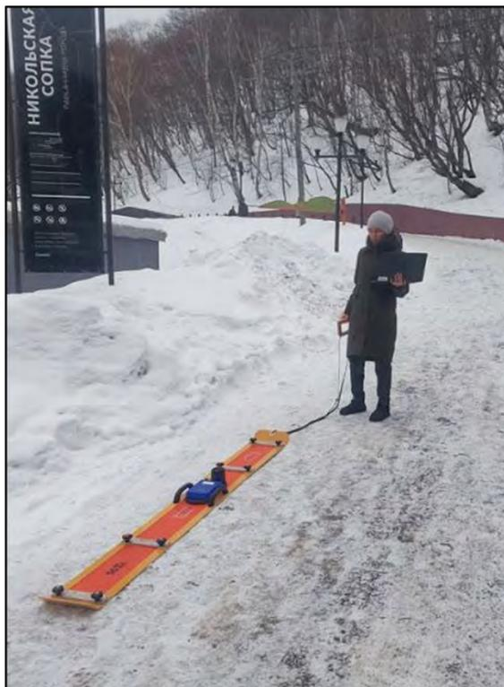
Рис. 3. Оператор с георадаром «Тритон-М»
