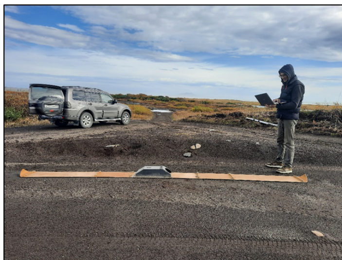
Рис. 3. Оператор с георадаром «ПИТОН-3» (Камчатка)
