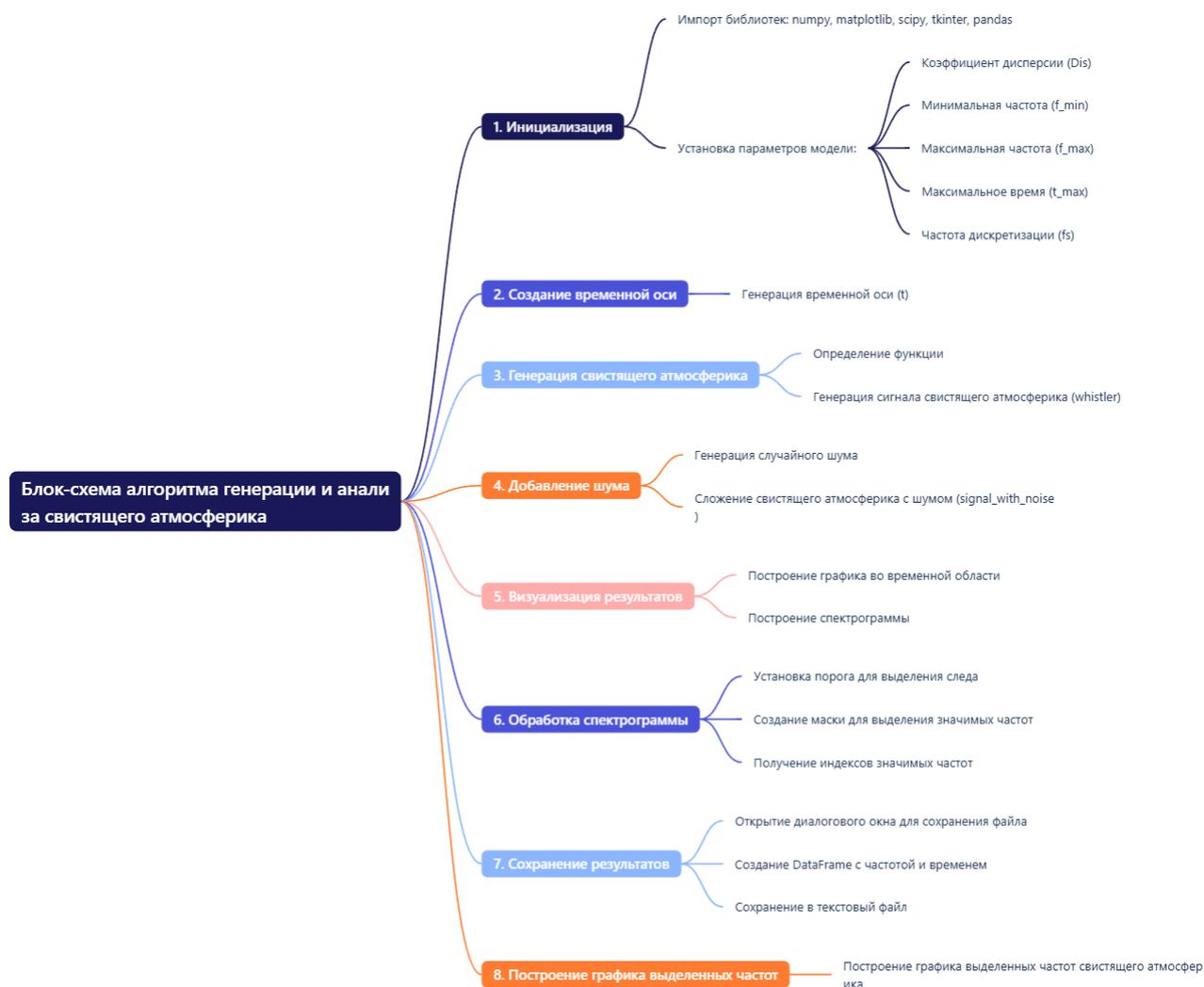
Рис. 1. Блок-схема алгоритма в среде PyCharm.
