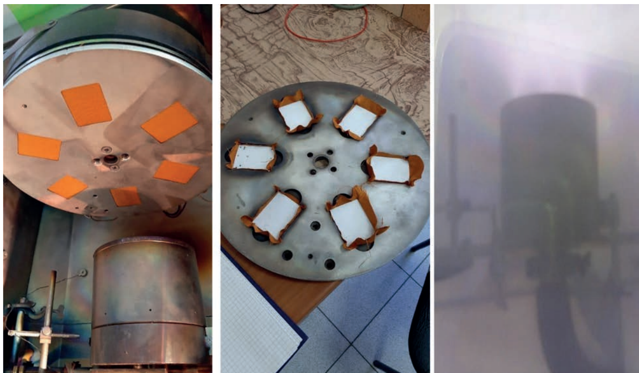
Рис. 1. Внешний вид установки для обработки низкотемпературной плазмой (слева). Вид образцов ткани с теневой стороны (в центре). Процесс плазменной обработки (справа).
