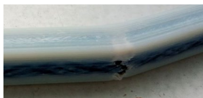
Рис. 8. Характерное разрушение образцов групп 4 – 6 в виде брусков и группы 7 в виде цилиндров с сетчатым цилиндрическим армированием – растяжение
