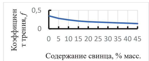
Рис. 5. Влияние содержания свинца в композиционном материале Al – Pb на коэффициент трения (без смазки)
