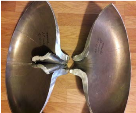
Рис. 2. Вытекание шва СТП при осадке обечайки в горячую форму
