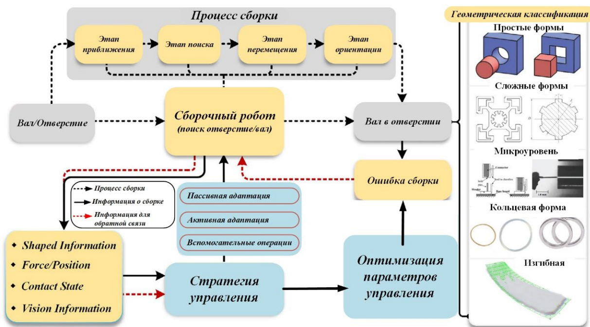
Рис. 1. Схема процесса роботизированной сборки и геометрическая классификация
