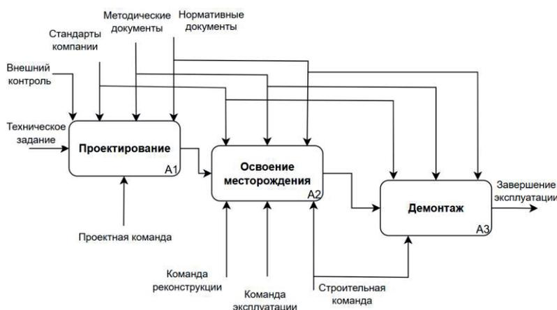
Рисунок 1 – Схема декомпозиции стадий ЖЦ объектов обустройства месторождений уровня А0
