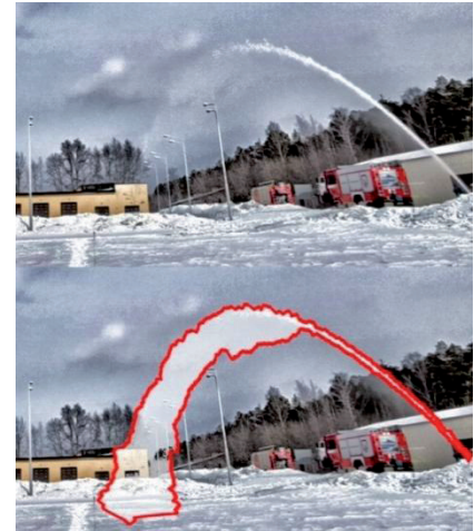
Рисунок 5 – Фрагменты изображения струи огнетушащего вещества из ПЛС после предварительной обработки (вверху) и выделения границ (внизу)
