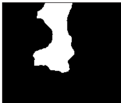
Рисунок 14 - Пример адаптивного порога на основе среднего значения
