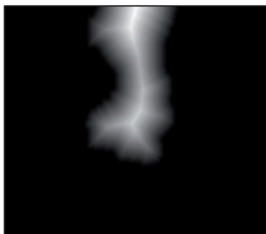
Рисунок 13 - Пример нормализованного Евклидова преобразования расстояния
