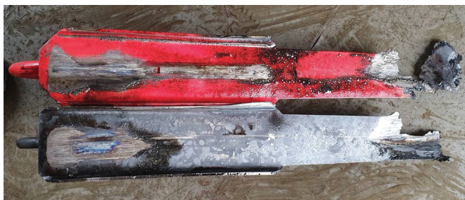
Рис. 13. Внешний вид стояночных башмаков после прохода 1,6 км по смазанным рельсам со скоростью 3–5 км/ч
