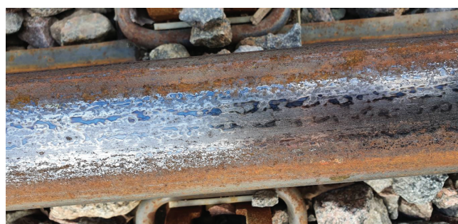
Рис. 11. Пятна металла, перенесенного на рельс с башмаков
