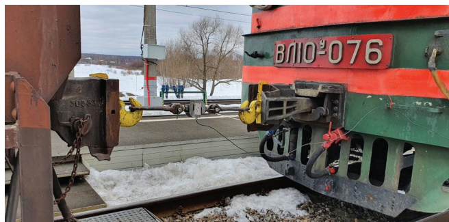
Рис. 6. Весоизмерительное устройство ТВЕУ-20Г: крепление упругого элемента весоизмерительного устройства на автосцепках вагона и электровоза
