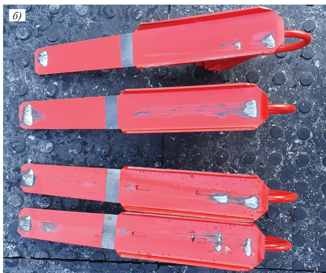
Рис. 8. Сдираание краски с окрашенных полозьев стояночных башмаков:
