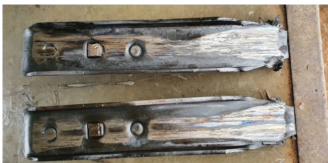
Рис. 14. Внешний вид горочных башмаков после прохода 2 км со скоростью 2–4 км/ч
