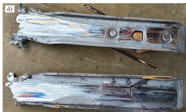
Рис. 12. Ползья башмаков после скольжения со скоростью 6–9 км/ч: а — стояночных на дистанции 880 м; б — горочных на дистанции 2 км
