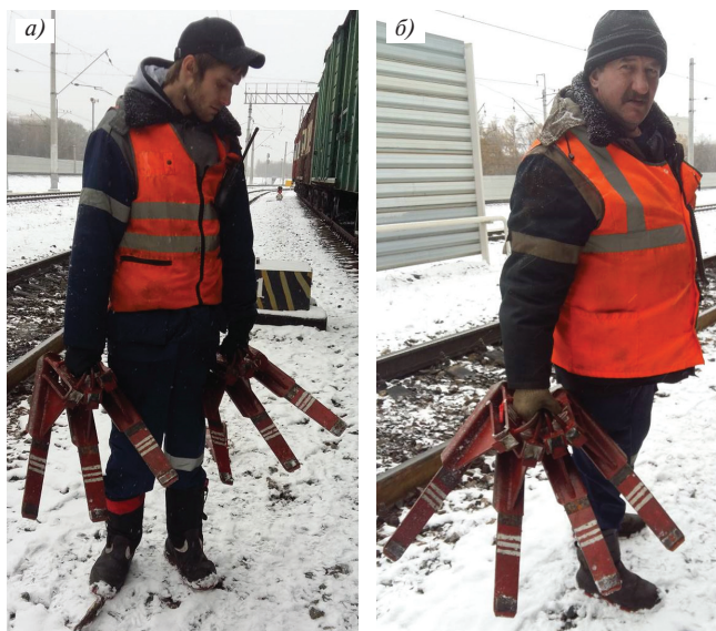
Рис. 4. Возможность переноса стояночных башмаков: а — одновременно 6 шт.; б — удержание в одной руке четырех башмаков, при этом возможен перенос 8 шт.
