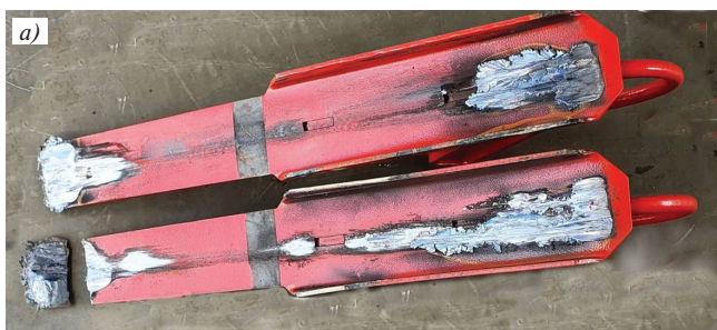
Рис. 9. Полозья башмаков после скольжения со скоростью 3–5 км/ч на дистанции 2 км:
