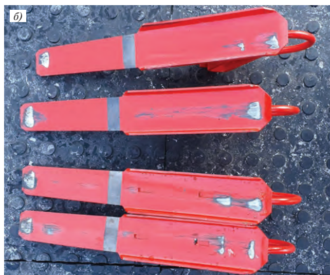
Рис. 8. Сдираание краски с окрашенных полозьев стояночных башмаков:
