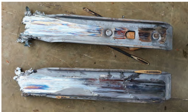
Рис. 15. Внешний вид горочных башмаков после прохода 1,9 км по смазанным рельсам со скоростью 6–9 км/ч
