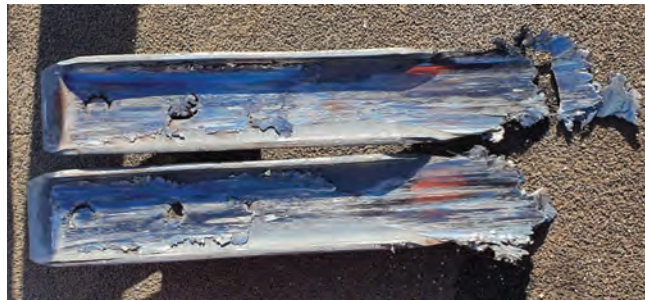
Рис. 10. Состояние горочных тормозных башмаков после скольжения 8 км под колесной парой с нагрузкой 18 тс со скоростью 3–5 км/ч
