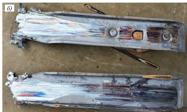
Рис. 12. Полозья башмаков после скольжения со скоростью 6–9 км/ч: а — стояночных на дистанции 880 м; б — горочных на дистанции 2 км
