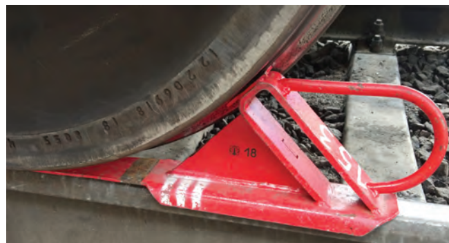
Рис. 1. Стояночный башмак производства ФГУП «ПО «Октябрь»», 2018 г.
