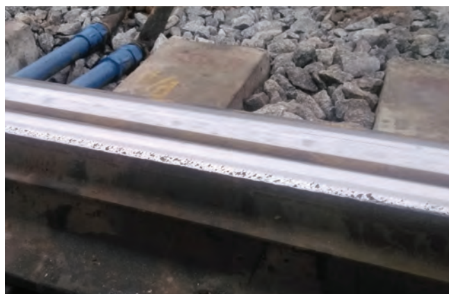
Рис. 3. Выкрашивание металла на рабочей поверхности остряка типа Р65 из-за воздействия колес с повышенной нагрузкой
