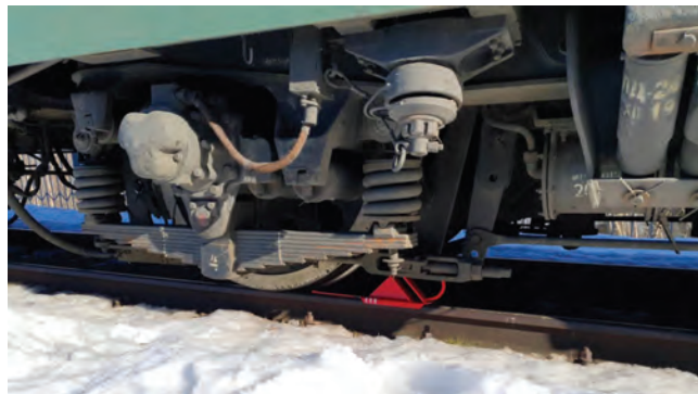
Рис. 3. Установка стояночных башмаков под второе колесо первой тележки электровоза ВЛ10
