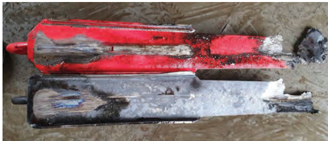
Рис. 13. Внешний вид стояночных башмаков после прохода 1,6 км по смазаным рельсам со скоростью 3–5 км/ч
