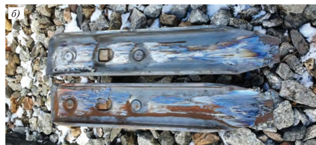
Рис. 9. Полозья башмаков после скольжения со скоростью 3–5 км/ч на дистанции 2 км:
