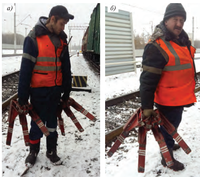
Рис. 4. Возможность переноса стояночных башмаков: а — одновременно 6 шт.; б — удержание в одной руке четырех башмаков, при этом возможен перенос 8 шт.
