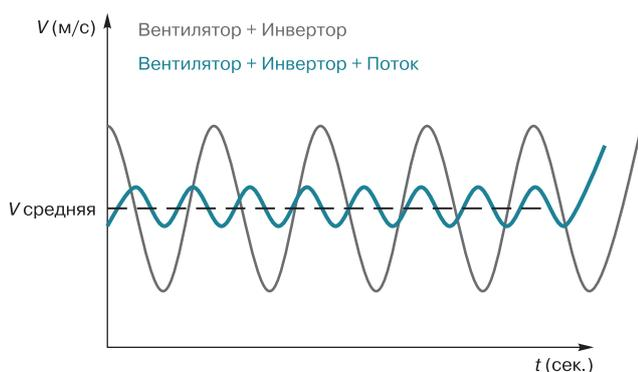
Рис. 4. Колебания скорости потока воздуха в различных системах\*
