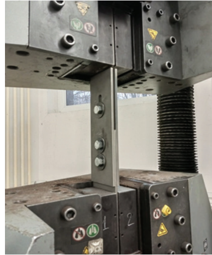
Рис. 4. Испытание образцов на растяжение в разрывной машине
