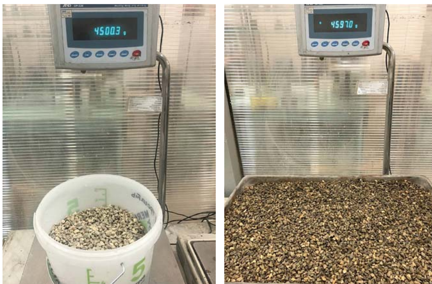
Рис. 4. Определение содержания пылевидных и глинистых частиц в доломитовом заполнителе
