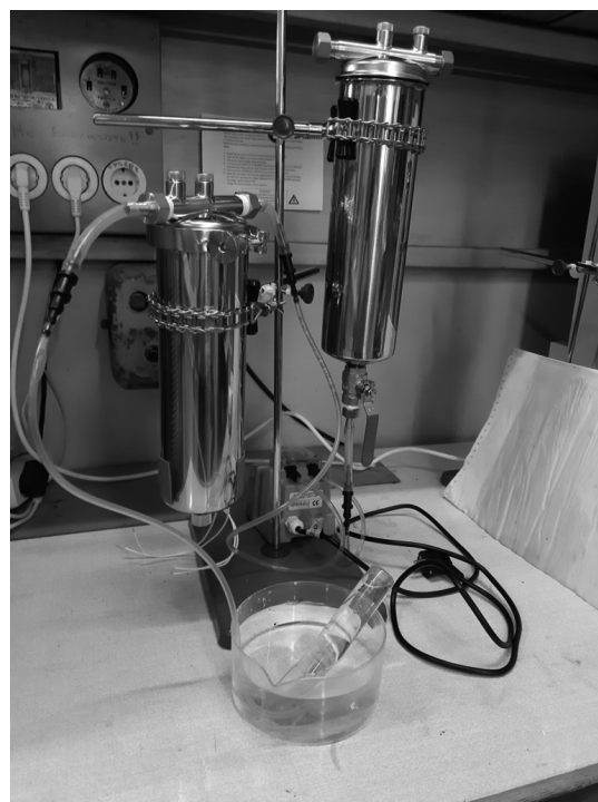
Рис. 3. ГВ проточного типа в сборке включает: реакторный блок с обогреваемым корпусом (слева на рисунке), емкость для щелочного раствора боргидрида натрия, перистальтический насос для подачи раствора \text{NaBH}_4 в реакторную зону гидролиза
