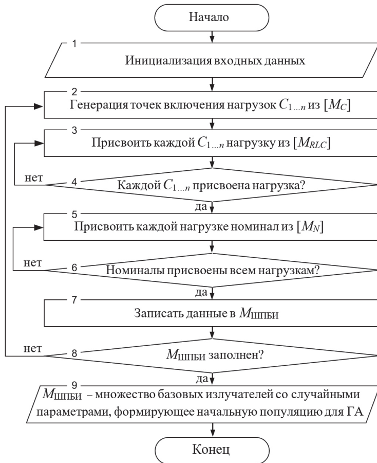
Рис. 3. Механизм формирования начальной популяции для генетического алгоритма
