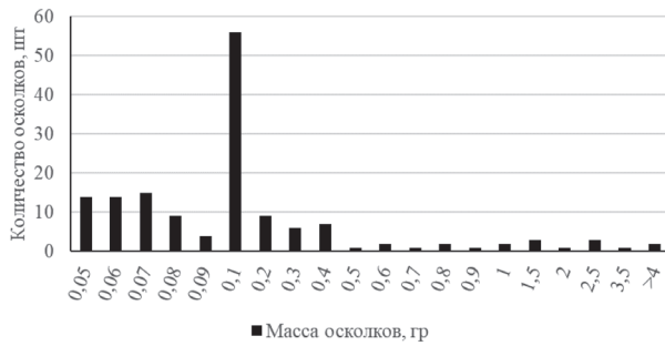
Рис. 7. Распределение по массам убийных осколков, образующихся при подрыве мин ПОМЗ-2М
