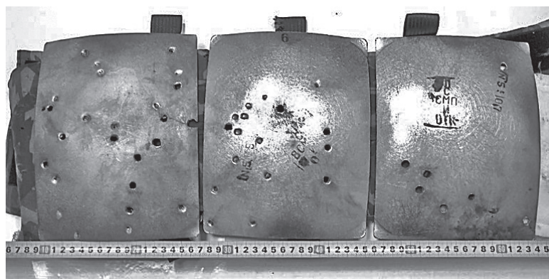
Рис. 17. Вид ЗС, состоящей из бронепластин из титанового сплава толщиной 4 мм, после испытаний подрывом мины МОН-50 на расстоянии 5 м (сквозные пробоины защитной структуры)
